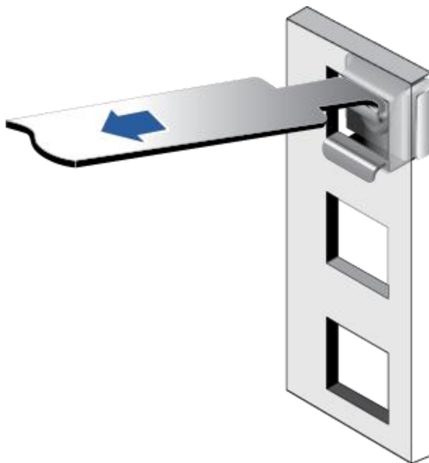
图 6-6 在机柜中安装浮动螺母
