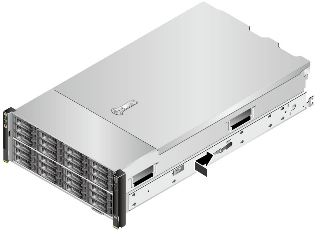
图 9-13 安装内轨到机箱
