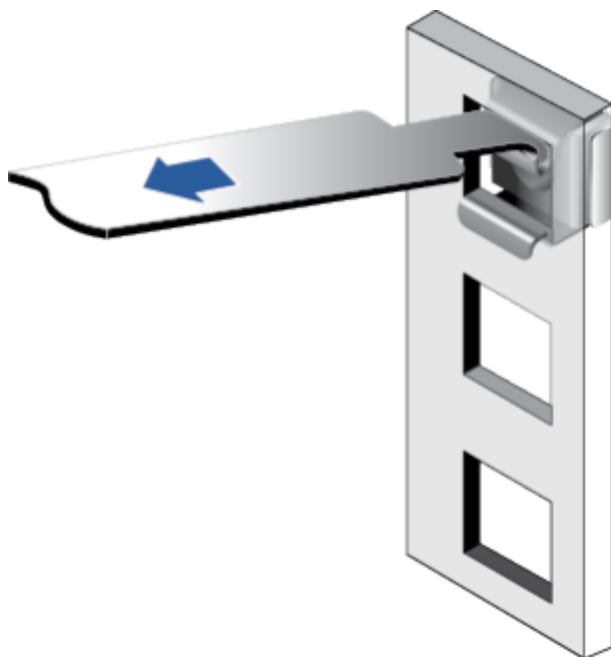
图 6-5 在机柜中安装浮动螺母
