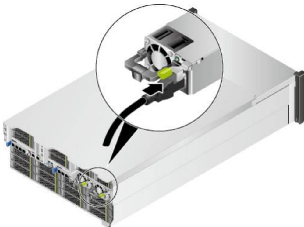
图 6-19 连接电源线缆
