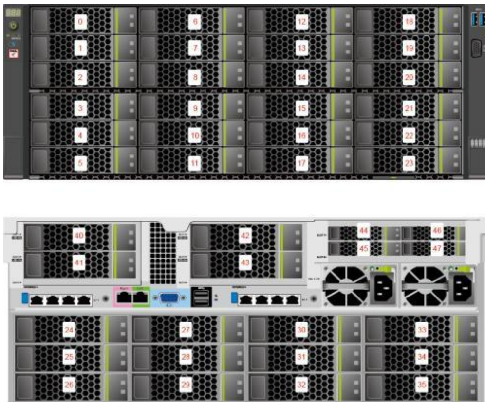
图 3-7 36x3.5 英寸 EXP 机型的硬盘编号
