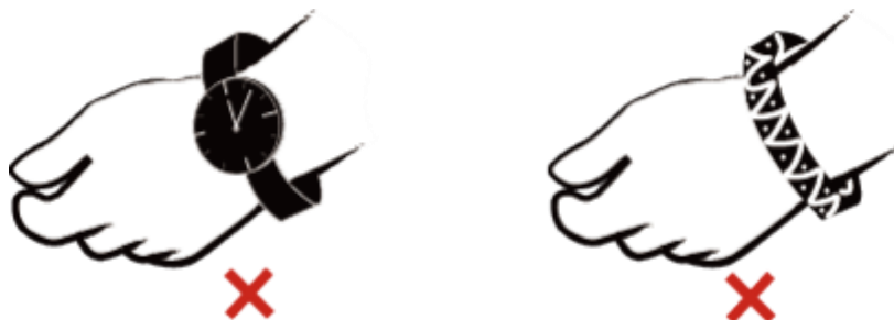
图 6-1 去除易导电的物体
