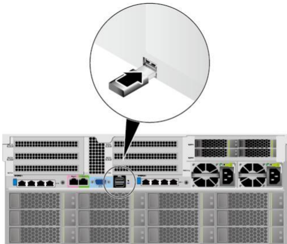
图 6-17 连接 USB 接口
